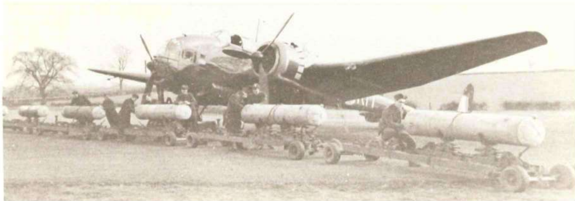
Hampden op vliegveld. Op de karretjes in dit geval anti schip mijnen.
