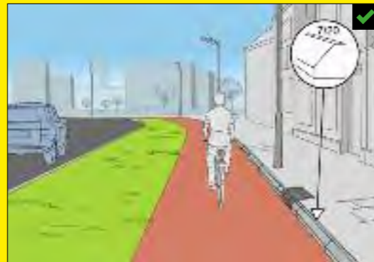
Fietspad bij voorkeur 2,50 m breed (minimaal 2,25 m). Als fietspad niet kan, een fietsstrook bij voorkeur 2,00 breed (minimaal 1,75 m).
