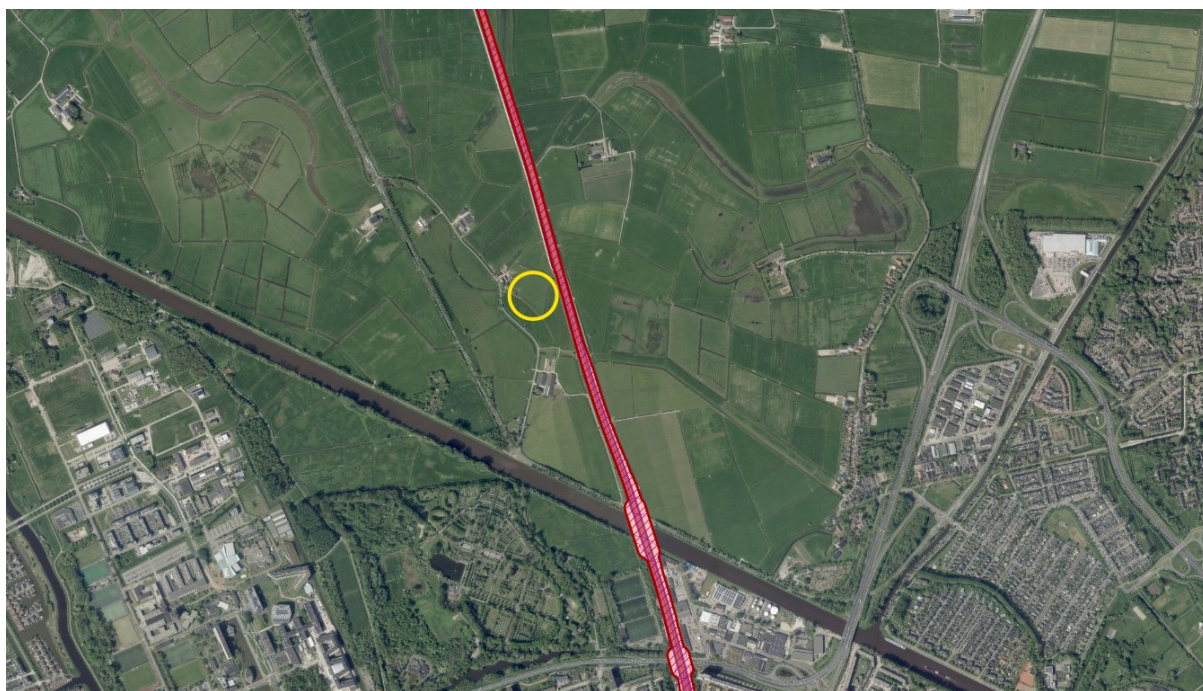
Figuur 4-1 Werkzaamheden kabeltracé (geel omlijnd) ten opzichte van het beperkingengebied hoofdspoorwegen (rood)
