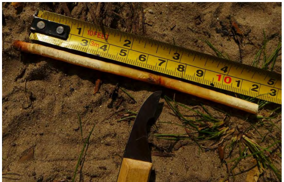
Foto 11: Een houtmonster uit een populierentak. De schors aan de buitenzijde van de tak bevindt zich op deze foto linksboven. De 'Natte kern' is herkenbaar aan de bruine verkleuring van het hout vanaf ruim 4 cm tot 10 cm diepte. Het mesje markeert het (donkere) hart van de tak. Het verkleurde houtweefsel is zijn stijfheid verloren en extreem buigzaam.
