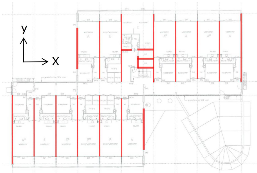
Figuur 4: Stabiliteitssysteem in beide hoofdrichtingen
