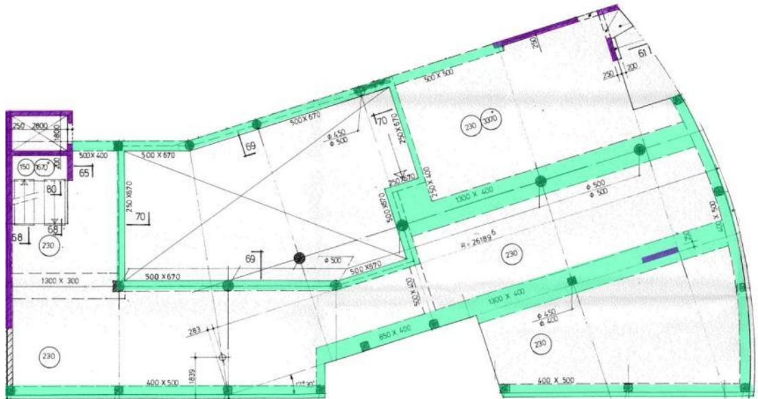
Figuur 15: Stabiliteitswanden (paars) en versterkte stroken (groen) bouwdeel C
