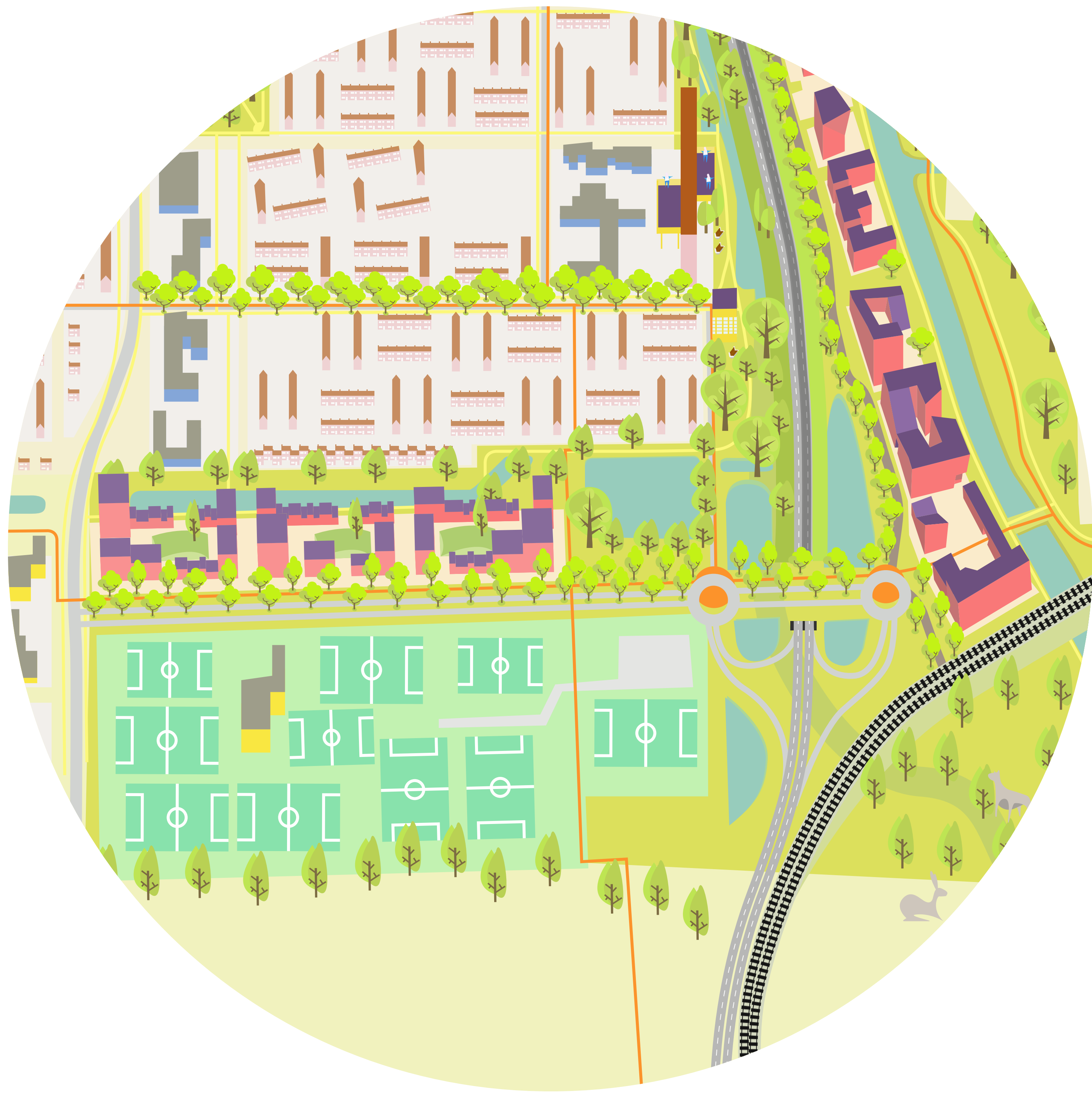
Voorbeelduitwerking 'Groen': half klaverblad, groen en waterberging rondom de aansluiting, alleen bebouwing langs Vinkhuizen
