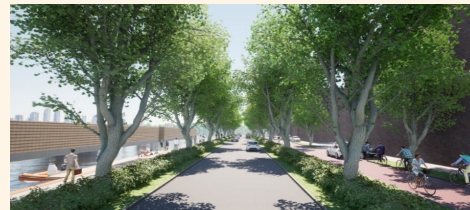
0. Laan variant (50km/u): Een gebiedsontsluitingsweg met 50km/u met aan weerszijden een haag en bomenrijen.
