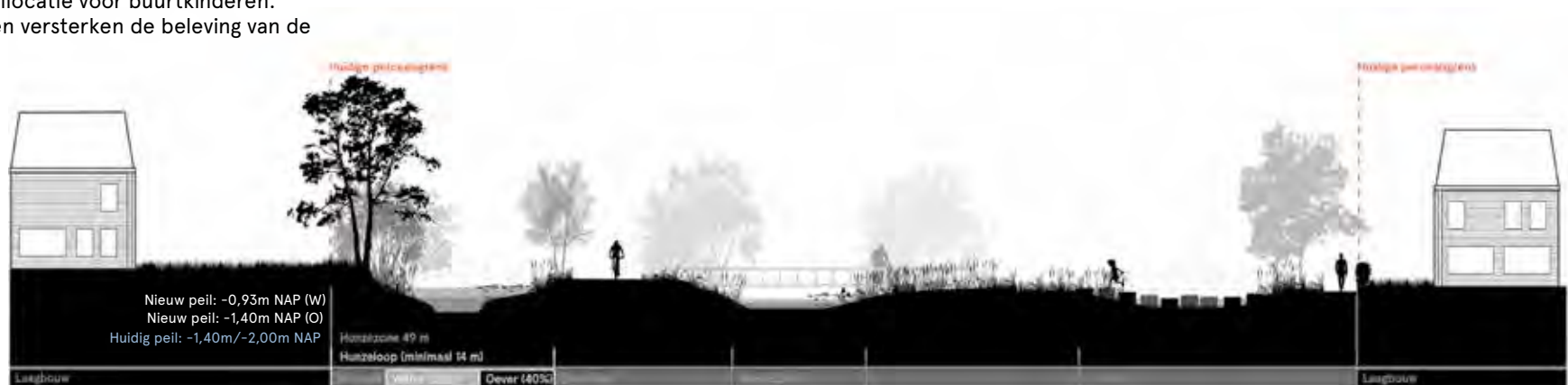
77 Principe doorsnede - Laagbouw en dubbele watergang
