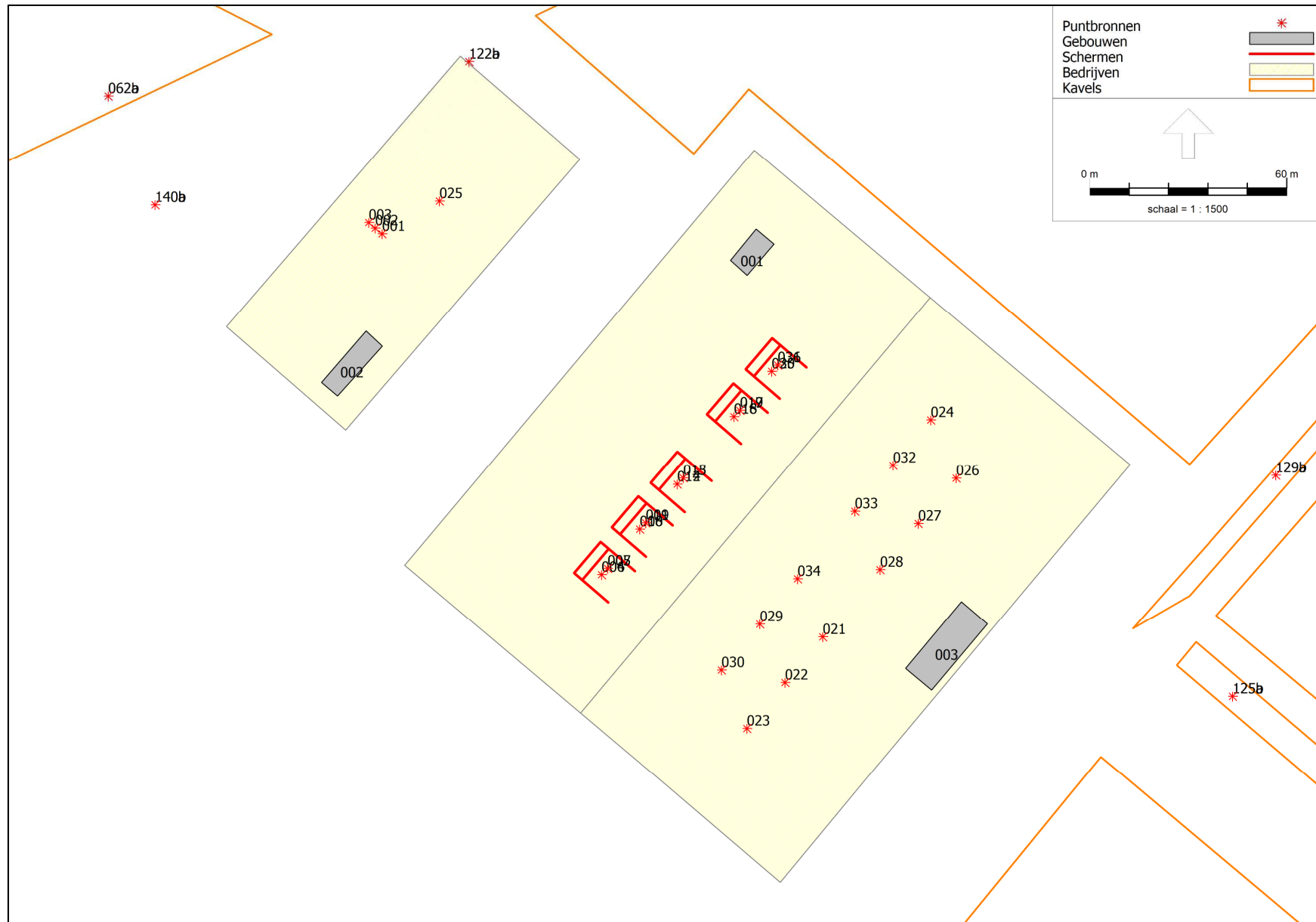
Figuur 1.4 Geluidbronnen trafostation, schakelstation en inkoopstation
