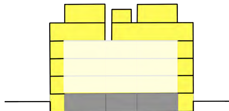
Nieuwbouw Optoppen van bestaande casco Aanbrengen nieuwe gevelstructuur
