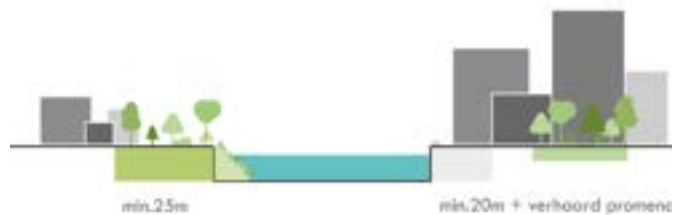
Principe doorsnede stedelijk oever
