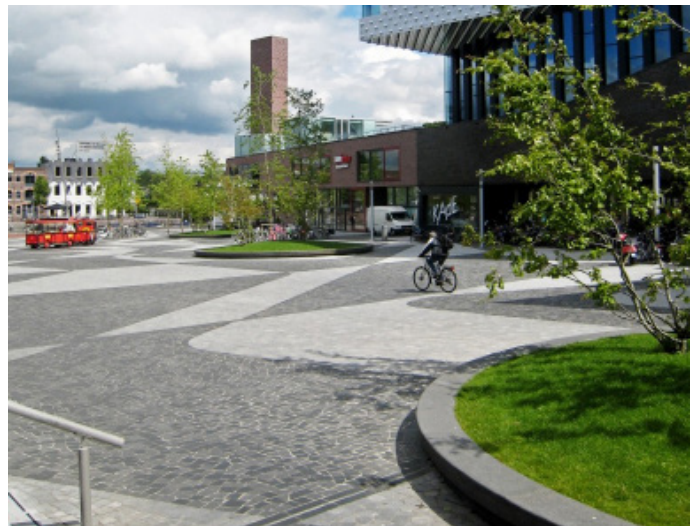
Afbeelding 90: Een hellingspercentage van maximaal 4% is geschikt voor fietsers en rolstoelgebruikers | Eemplein, Amersfoort (Buro Sant en Co)
