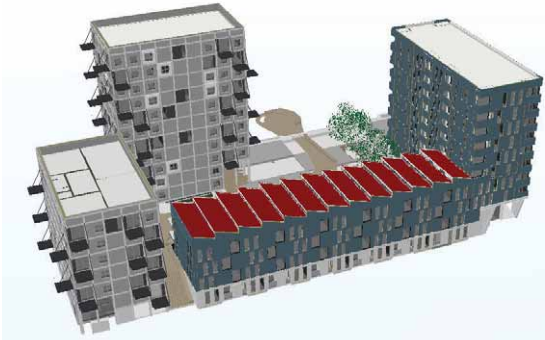
Figuur 13: Daken met extra geluidswering
