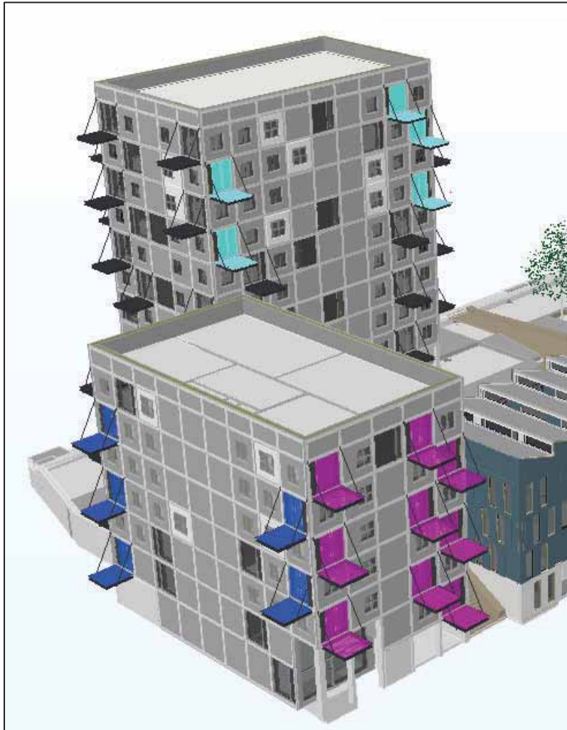
Figuur 4: Afschermende werking van balkons
