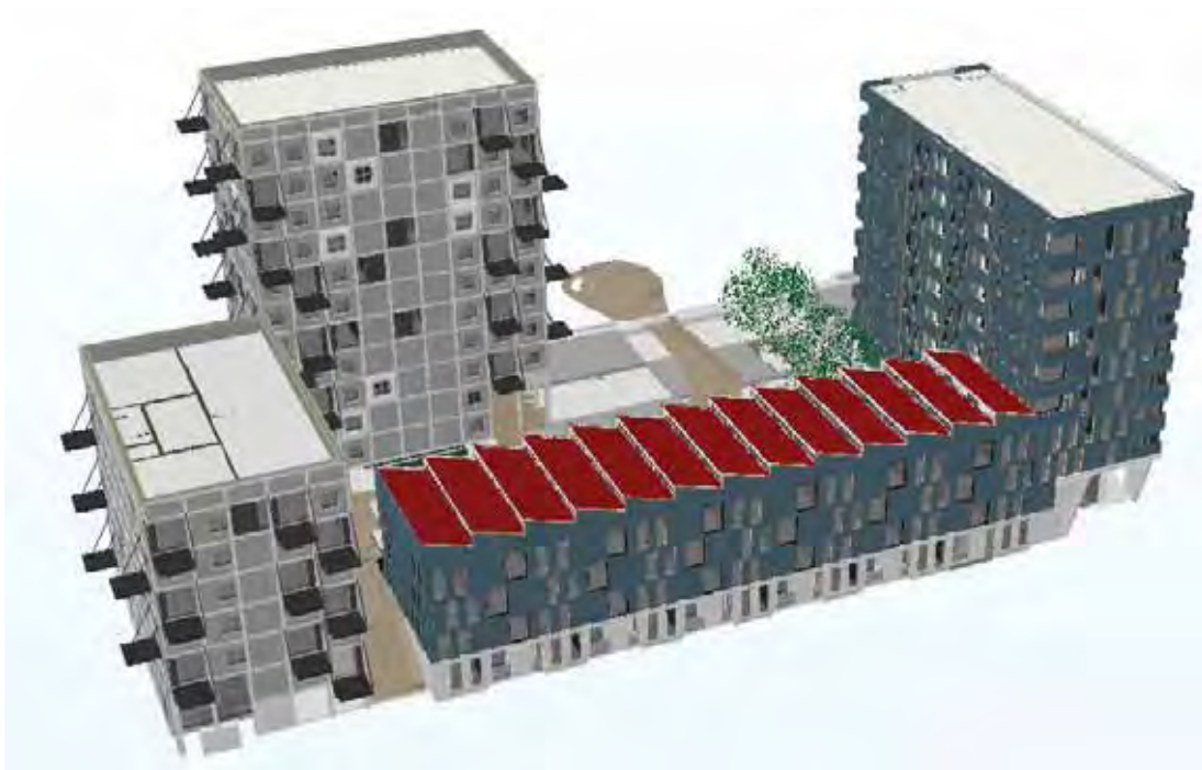
Figuur 13: Daken met extra geluidswering
