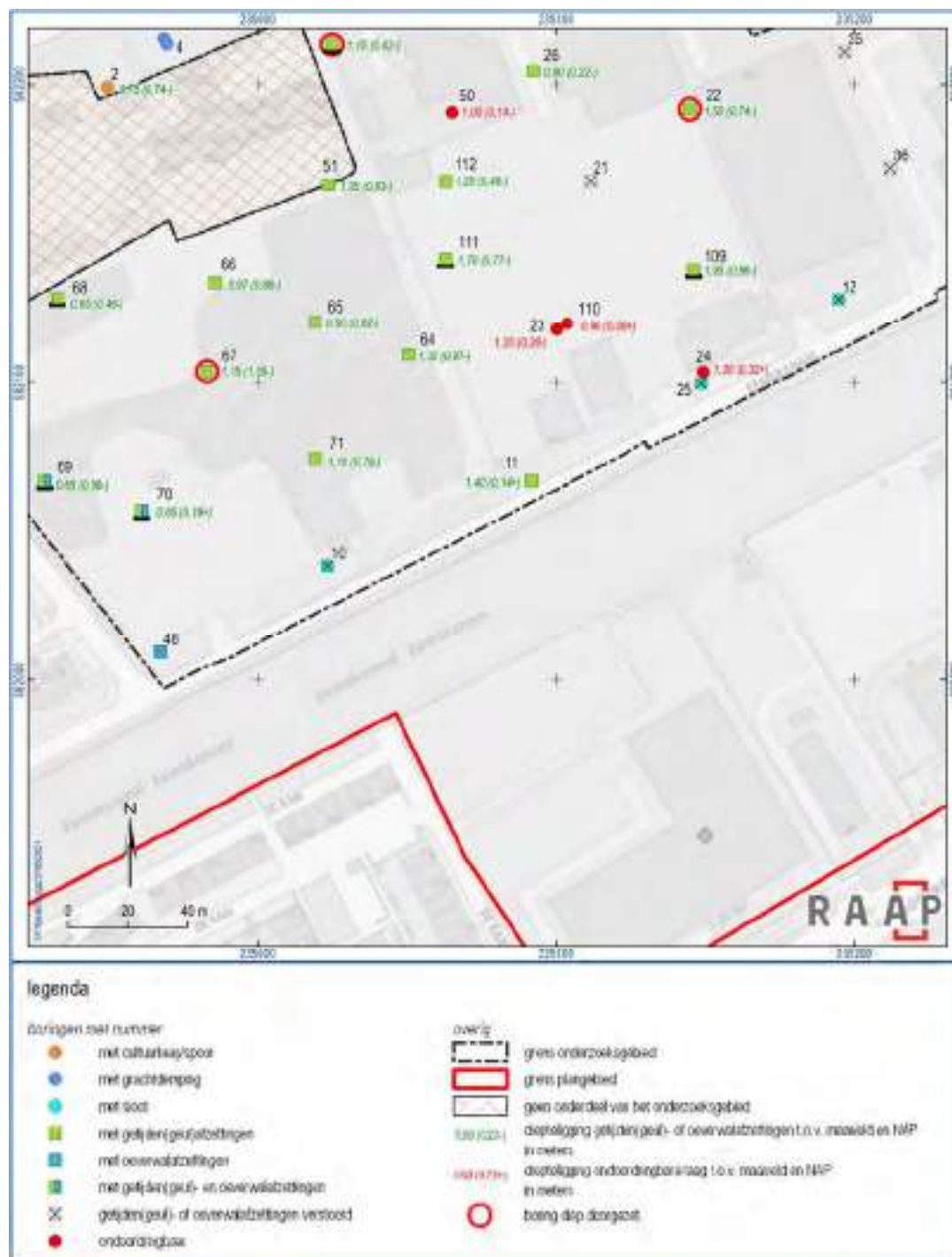
Figuur 18. Boringen 10, 12 en 25 die mogelijk op de locatie van de dijksloot van dijk van het Eemskanaal staan.
