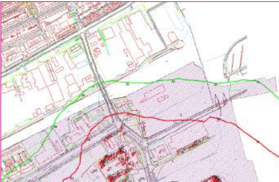
Figuur 0-11 Contouren IL na dezoneren op 25 meter hoogte (groen: 50 dB(A), rood: 55 dB(A))
