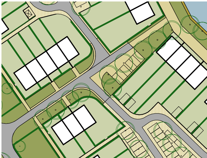
Figuur 3.35: Alle woningen zijn georiënteerd op de dwarsstraat door voordeur en/of ramen (sociale controle). Het bezoekersparkeren is informeel, enigszins uit het zicht opgelost. Toegangen tot de binnenterreinen zijn smal vormgegeven.
