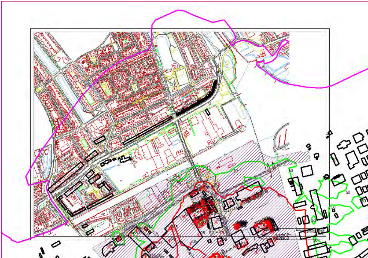
Figuur 6-5 overzicht van de huidige planologische geluidzone (paars) en de berekende 50 dB(A)/55 dB(A) etmaalwaardecontouren na dezonering groen: L_{etm} = 50 \text{ dB(A)} rood: L_{etm} = 55 \text{ dB(A)}
