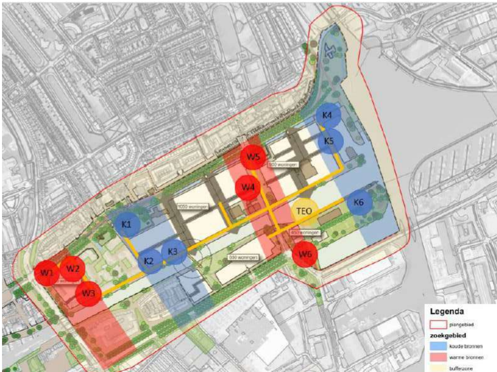
Figuur 0-5 schematische weergave warmte- en koudebronnen. bron: scenariostudie energie RHDHV
