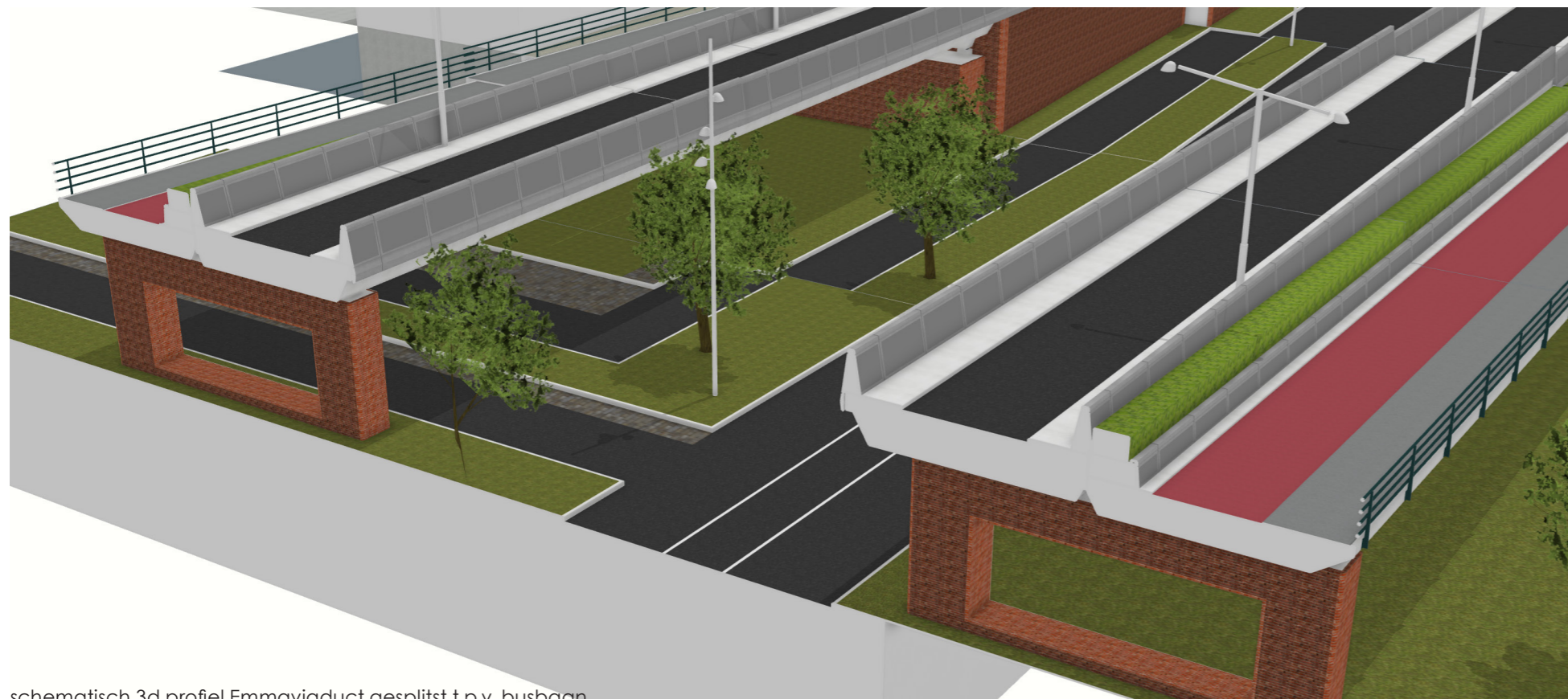
schematisch 3d profiel Emmaviaduct gesplitst t.p.v. busbaan
