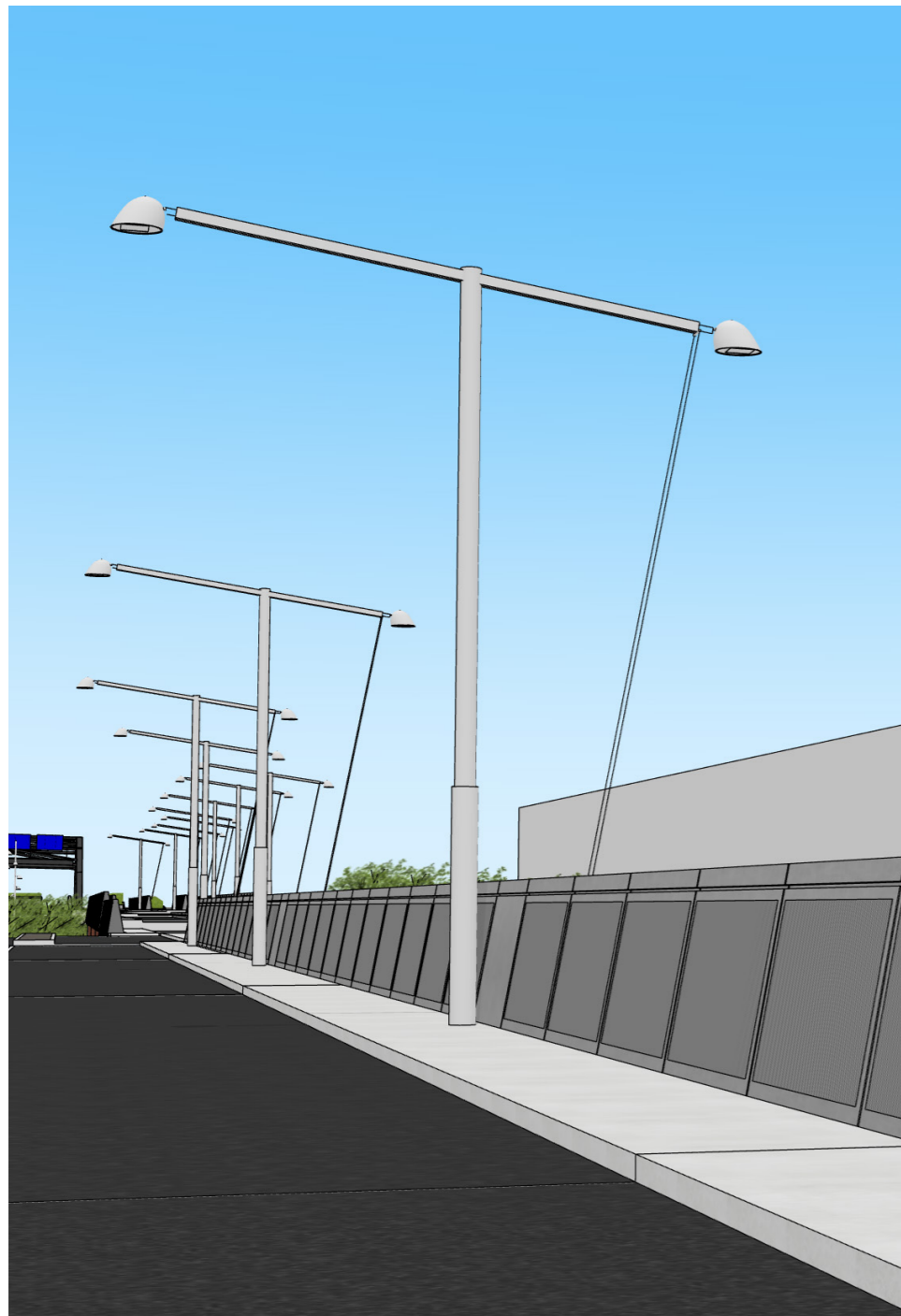
verlichtingsmast in het schampstrook Emmaviaduct richting Julianaplein
