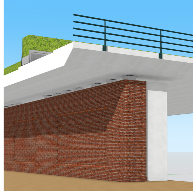
detail wand met oplegging - overgang naar bestaand
