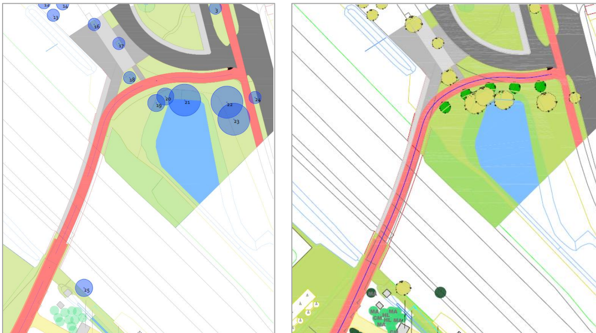
Afbeelding 53/54: Rechts het ontwerp, links de projectinvloedenkaart. De nieuwe aftakking van het fietspad vormt hier het belangrijkste onderdeel van het ontwerp. Het valt echter ook te voorzien dat vanaf dit punt de aan- en afvoer van materieel en materialen voor de reconstructie plaats zal vinden.
