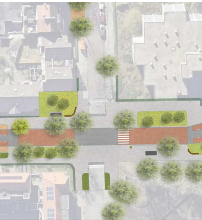
TROTTOIRS LIGGEN GROTENDEELS VRIJ VAN DE RIJBAAN GESCHIEDEN DOOR PLANTVAKKEN EN ZIJN UITGEVOERD IN BETONTEGELS (HERGEBRUIK)
