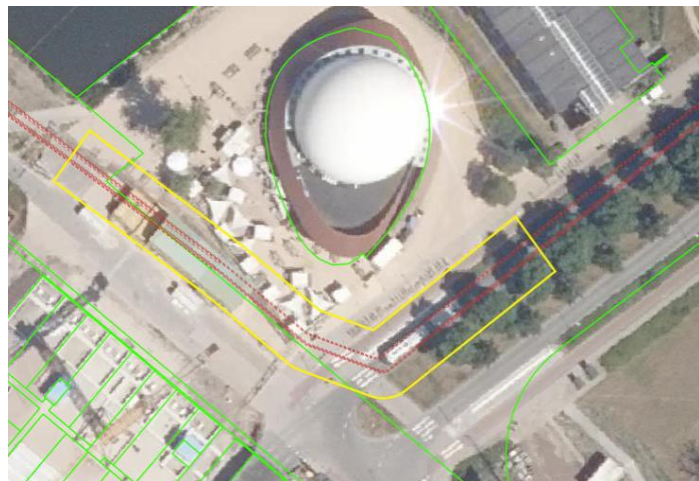
Figuur 1 Specifieke 0,4μT magneetveldzone bij DOT Groningen
