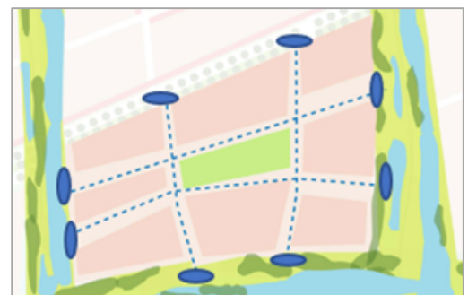
Figuur 12: Verdelingsdiagram volumes hemelwater bij berging aan de randen en 30 mm berging op particulier terrein
