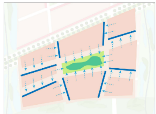
Figuur 11: Verdelingsdiagram volumes hemelwater bij berging op de wierden en 30 mm op particulier terrein
